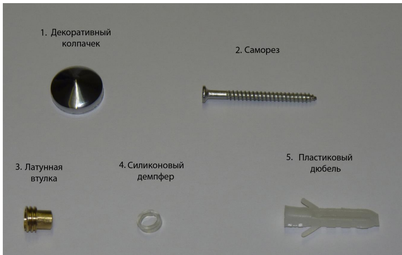
Рис.1 Внешний вид и комплектация крепежа кнопка-конус №5.
